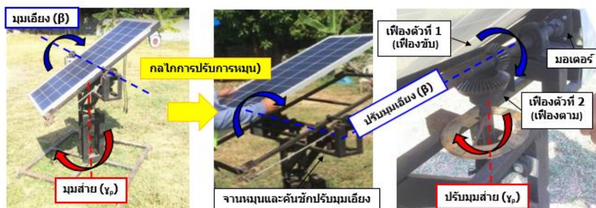
รูปที่ 6 กลไกปรับการหมุนของระบบระบบติดตามดวงอาทิตย์ด้วยมอเตอร์เดี่ยวปรับการหมุนแบบแกนคู่(SMDA)
