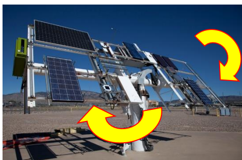
รูปที่ 2 ระบบติดตามดวงอาทิตย์ ชนิดมอเตอร์คู่ปรับการหมุนแบบแกนคู่(DMDA)
