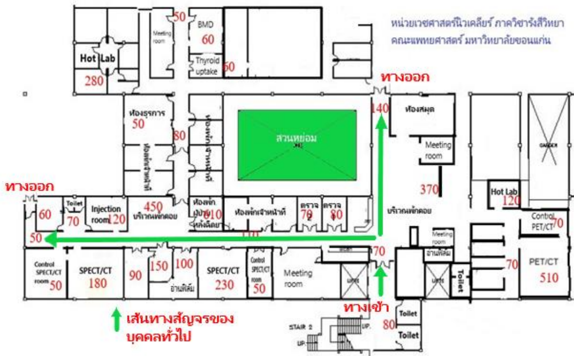
รูปที่ 3 แสดงผลการวัดรังสีตำแหน่งต่าง ๆ ( \mu\text{Sv}/\text{month} ) และเส้นทางสัญจรของบุคคลทั่วไป
