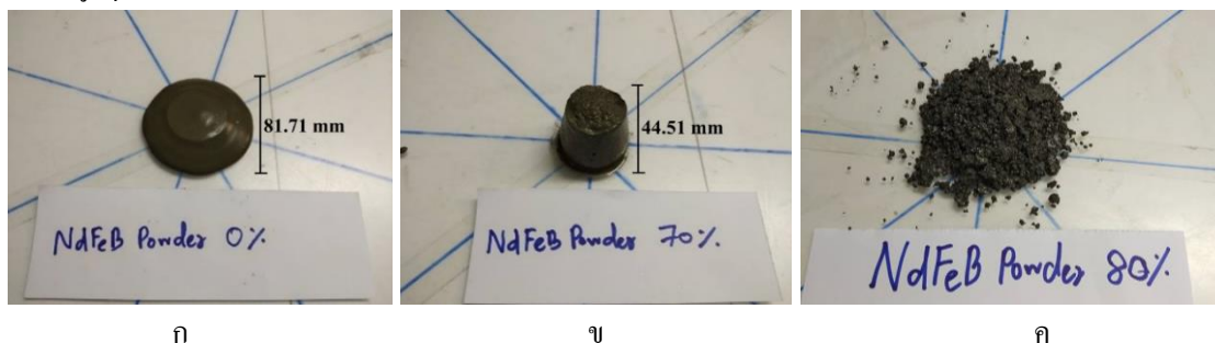
ภาพที่ 4 แสดงลักษณะการไหลตัวของซีเมนต์เพสต์ (ก) ค่าการไหลสูง (ข) ค่าการไหลต่ำ (ค) ไม่มีการไหล
