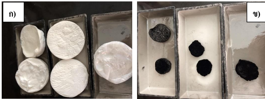
ภาพที่ 2 การเตรียมแผ่นคาร์บอนนาโนไฟเบอร์ โดยใช้แผ่นเซลล์โลสจากแบคทีเรียก่อนการเผา (ก) และหลังเผา (ข)
