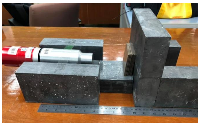
รูปที่ 1 ชุดอุปกรณ์ทดสอบการลดทอนรังสีแกมมาของวัสดุเชิงประกอบยางธรรมชาติ
