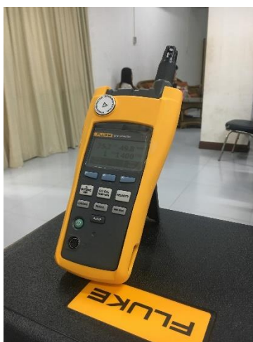
ภาพที่ 2 เครื่องมือ Fluke Air Meter 975 ใช้ในการตรวจวัดก๊าซคาร์บอนไดออกไซด์ ขณะใช้งาน
