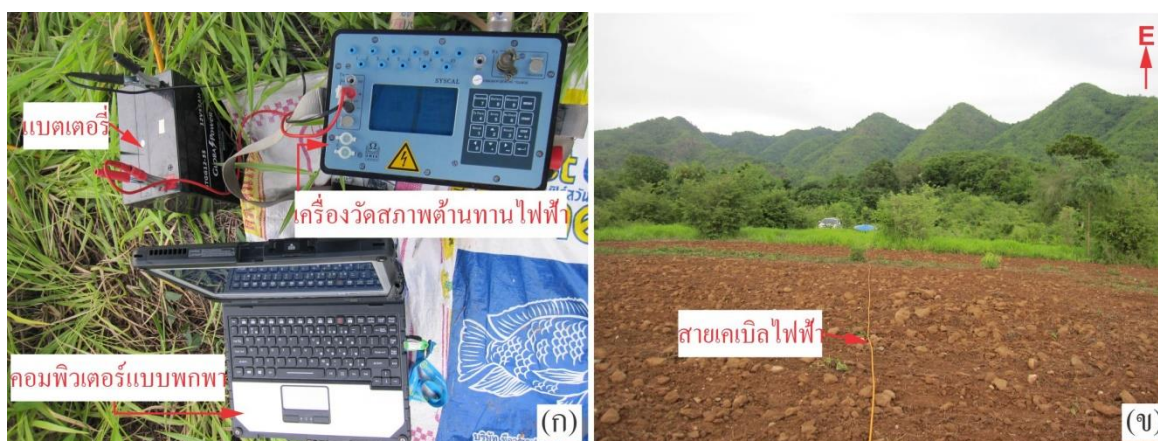
ภาพที่ 3 แสดงเครื่องมือและอุปกรณ์ที่ใช้ในการวัดสภาพต้านทานไฟฟ้าแบบ 2 มิติ (ก) แนวการสำรวจ 2D ERT (ข)
