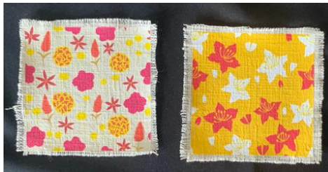
ภาพที่ 8 ภาพแสดงการทดลองเทคนิครีดร้อนลงบนผ้าฝ้ายโดยหมึก Pigment
