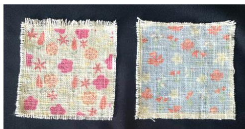
ภาพที่ 7 ภาพแสดงการทดลองเทคนิครีดร้อนลงบนผ้าฝ้ายโดยหมึก Sublimation
