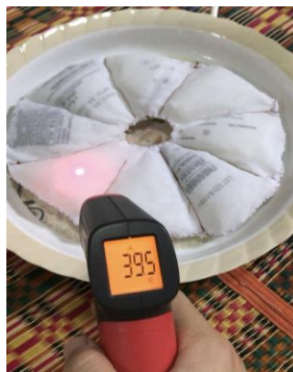
รูปที่ 1 การทดสอบอุณหภูมิแต่ละชั้นบนเจลประคบร้อน
