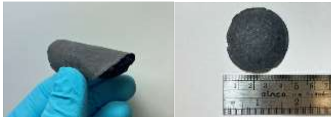
ภาพที่ 11 รูปถ่ายชิ้นงานวัสดุเทอร์โมอิเล็กทริกแบบยืดหยุ่น
