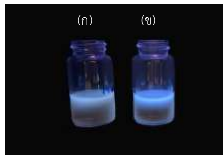
รูปที่ 3 คาร์บอนควอนตัมดอทภายใต้แสงอัลตราไวโอเล็ตที่ได้จากการสังเคราะห์ด้วยวิธีไมโครเวฟไฟโรไลซิส เมื่อใช้กำลังฟ้าของไมโครเวฟ (ก) 600 วัตต์ และ (ข) 800 วัตต์
