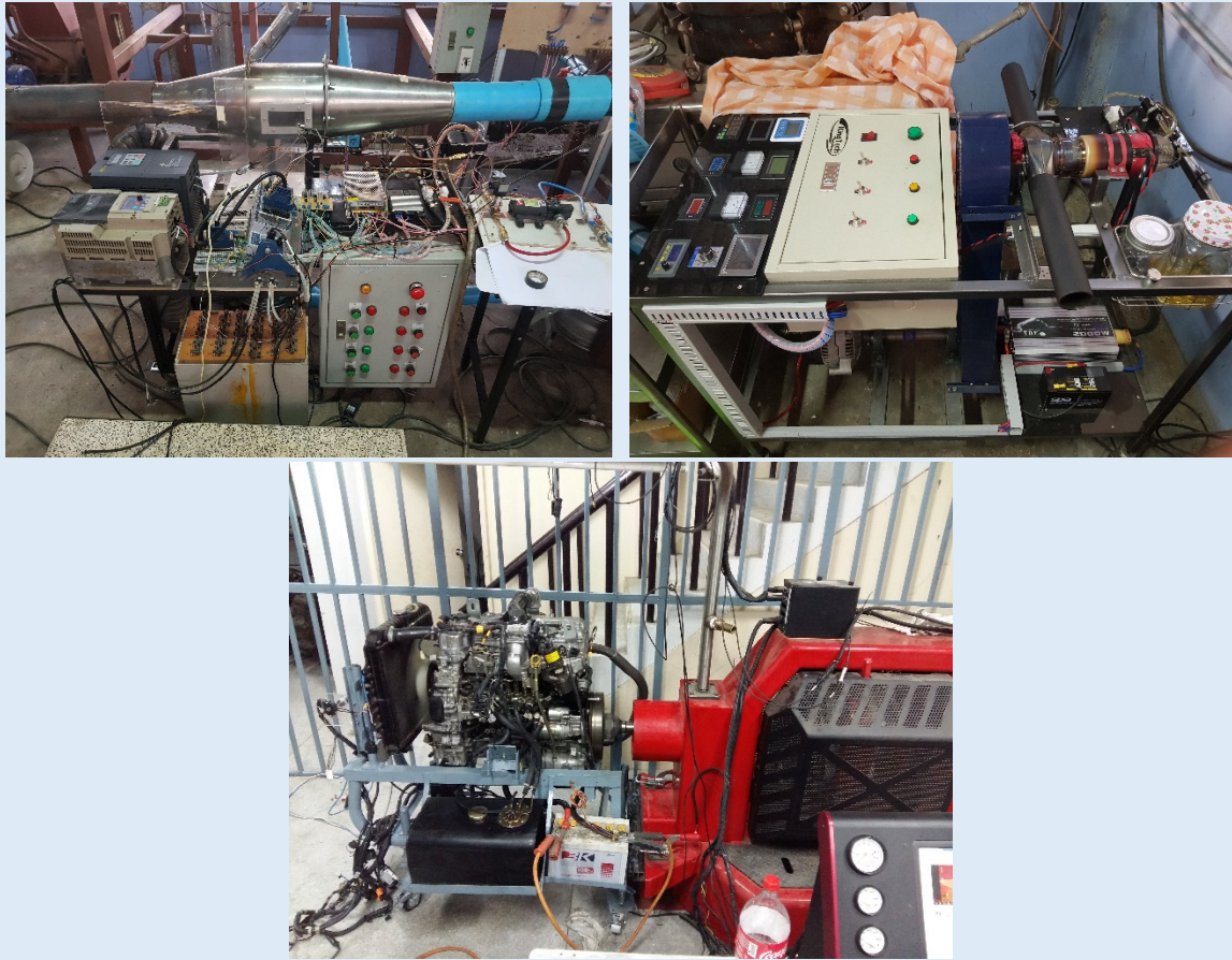
การต่อยอดงานวิจัยด้วยการนำไบโอดีเซลมาทดสอบห้องเผาไหม้จำลอง, เครื่องยนต์กังหันแก๊ส และเครื่องยนต์ดีเซล
